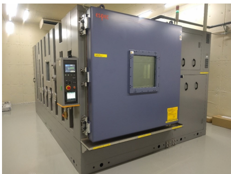
(b) 産業振興と人材育成の拠点エス・バード内の温度・高度・湿度耐候性着氷試験装置
