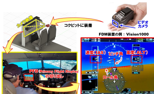
図8 小型航空機を対象にした FDM 装置の事故調査への活用
