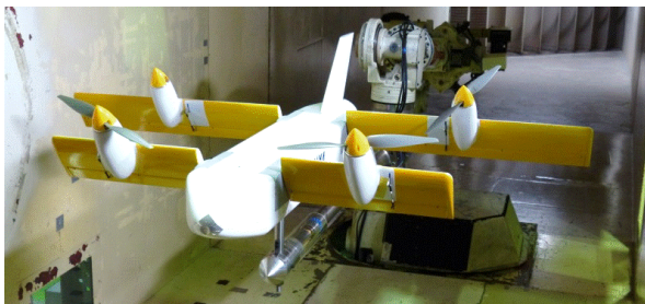
図10 JAXAが研究開発中のQTW(4発ティルトウィング型無人航空機VTOL(垂直離着陸))
