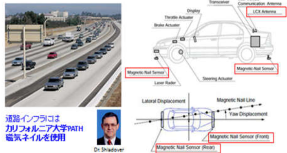
【図3】 実環境での道路インフラによる自動運転の試み
